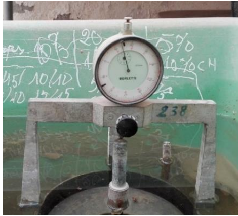
Figure IV.16 : Comparateur sur éprouvette mise en immersion.
