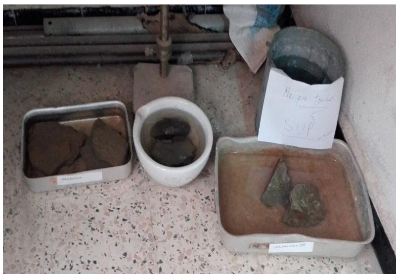
Figure III.5 : Mise en immersion des échantillons de marnes.
