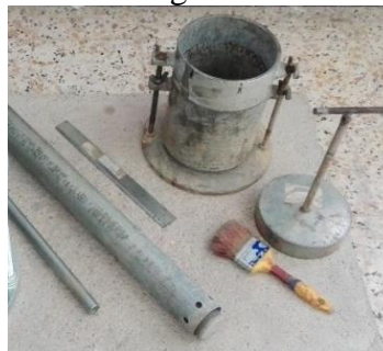
Figure IV.14 : Moule CBR et accessoires de compactage Proctor modifié.
