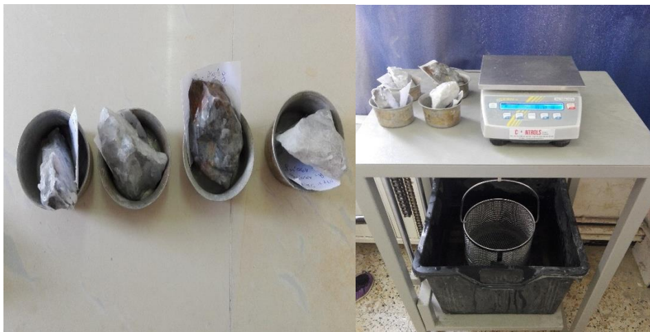
Figure III.13 : Échantillons paraffinés et matériels de pesée hydrostatique.
