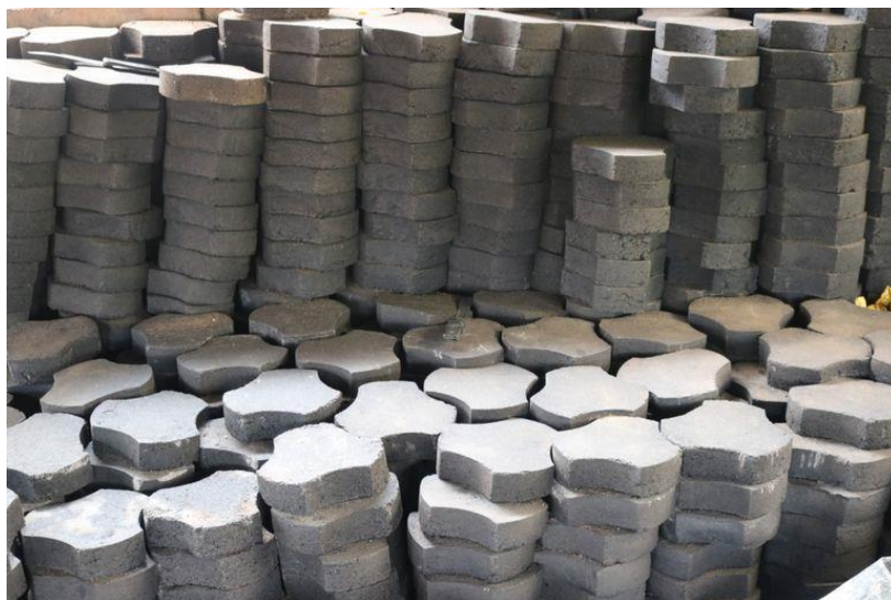
Figure II.8. : Pavés fabriqués à partir de déchets plastiques.
