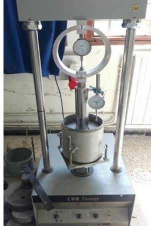
Figure IV.15 : Presse à poinçonnement CBR.
