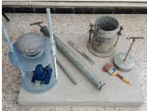
Figure IV.4 : Matériels utilisés pour l'essai Proctor modifié.
