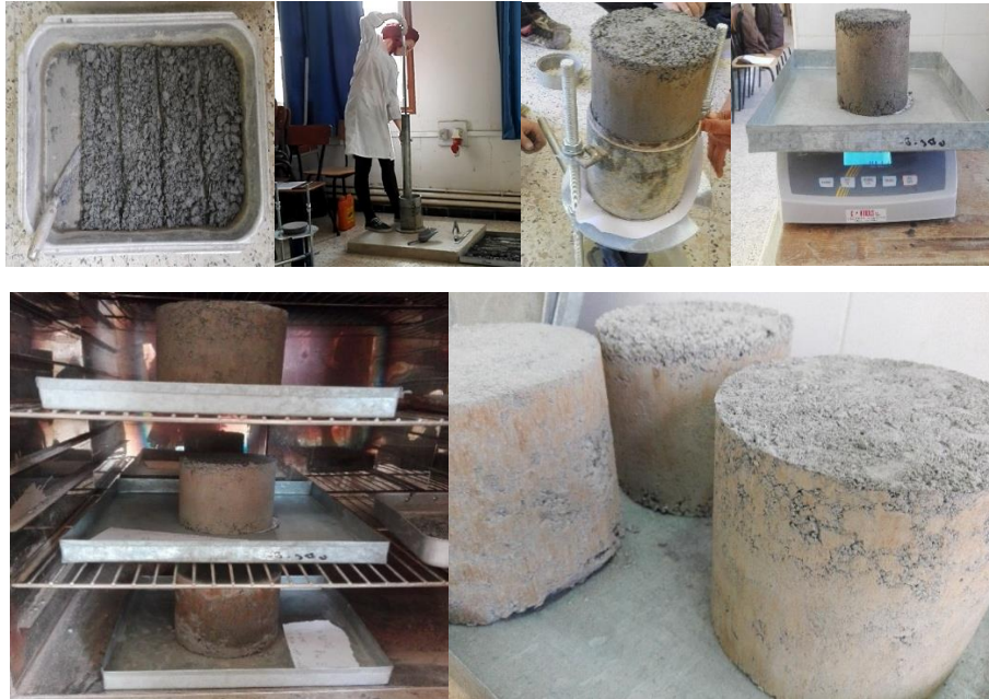
Figure IV.5 : Différentes étapes de l'exécution de l'essai Proctor modifié.
