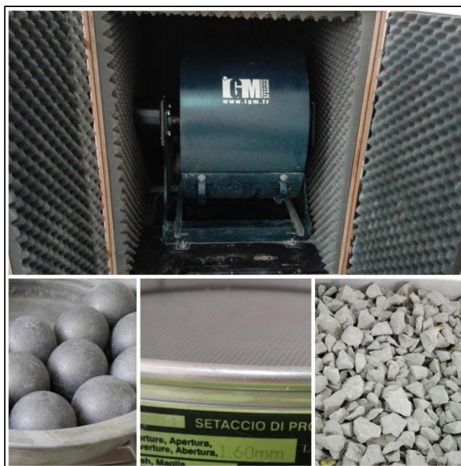
Figure V.1 : Matériels et échantillon de l'essai Los Angeles.
