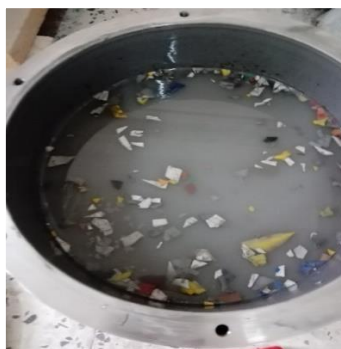
Figure V.4 : Ouverture du cylindre après essai en présence de déchets plastiques.
