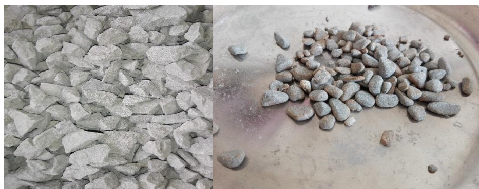
Figure V.5 : Usure des granulats après essai Micro Deval
