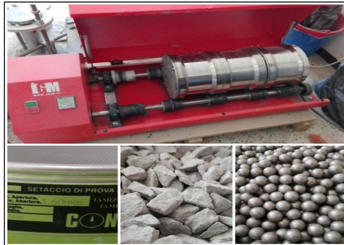
Figure V.3 : Matériels et échantillon pour l'essai Micro Deval.
