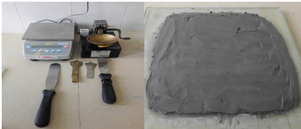
Figure III.15 : Appareillages et échantillon pour les limites d'Atterberg.
