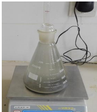
Figure III.12 : Pesée du pycnomètre contenant le matériau.
