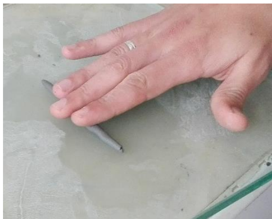
Figure III.17 : Rouleau pour déterminer la limite de plasticité.
