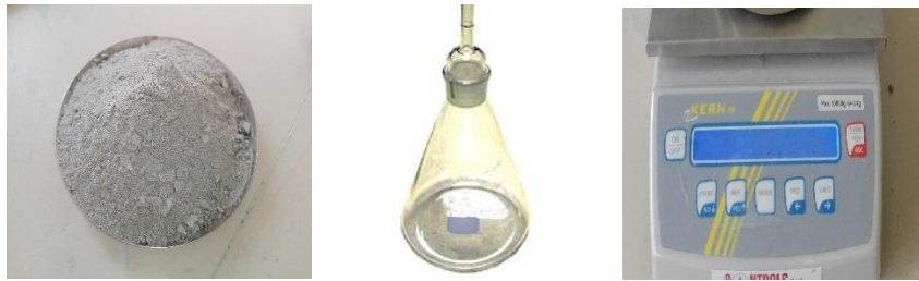
Figure III.11 : Matériels pour essai au pycnomètre.
