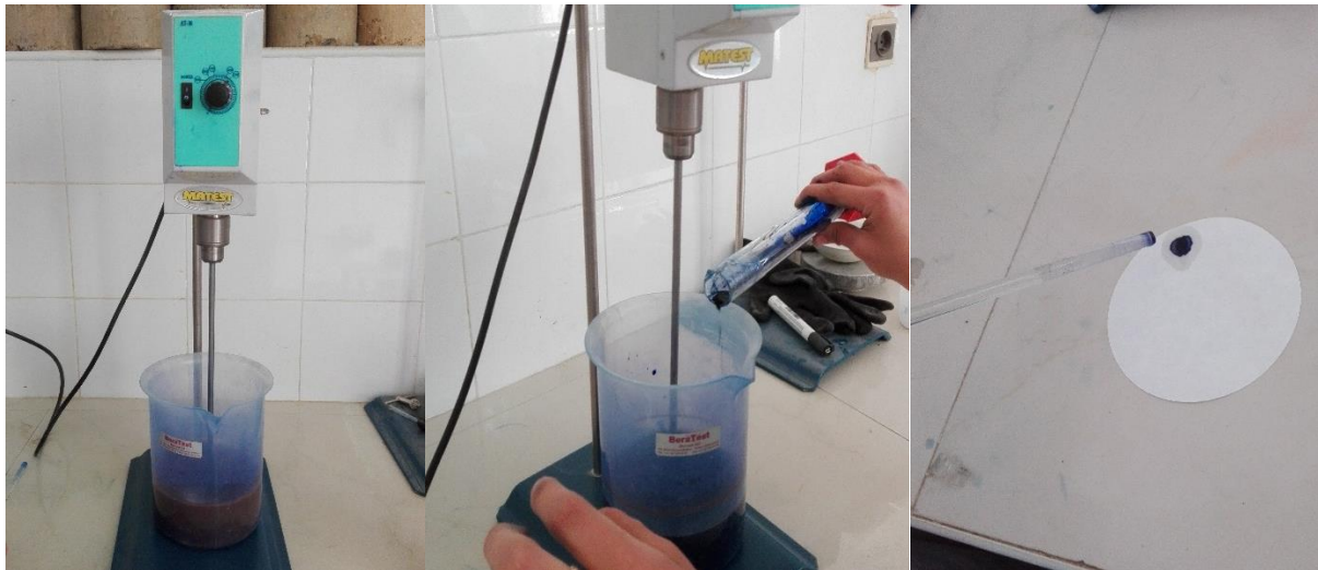
Figure III.18 : Mise en suspension des particules dans l'eau distillée, ajout du bleu de méthylène et prise de la tâche.
