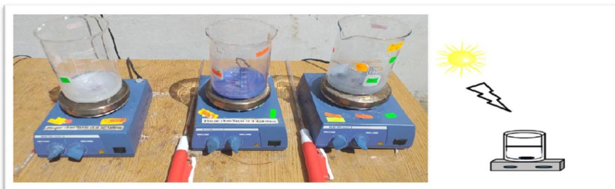
Figure II.5: Dispositif expérimental du photo-réacteur solaire
