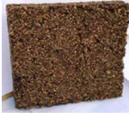
Figure 25 : Brique isolante à base du déchet oléicole Source : R. Toubal et Dahli (2010)
