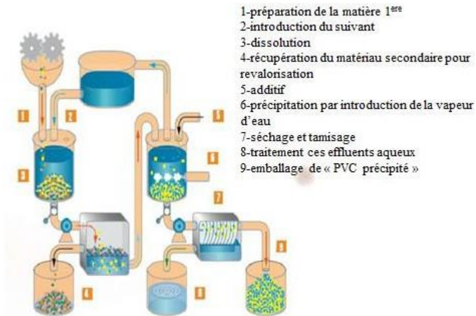
Figure 11 : processus du recyclage chimique Source : Http : //technostemarie314.eclablog.com/
