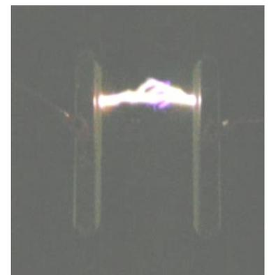
**FigV.22.3 :** Contournement de la plaque isolante
