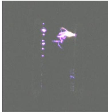
**FigV.16.2 :** Développement des zones sèches et apparition des arcs locaux
