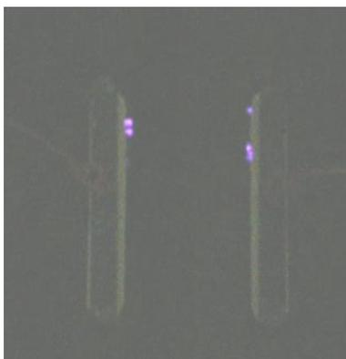
**FigV.22.1:** Naissance des décharges partielles au niveau de l'électrode terre
