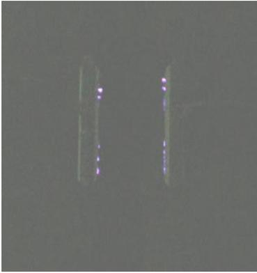
**FigV.23.1:** Naissance des décharges partielles au niveau de l'électrode terre
