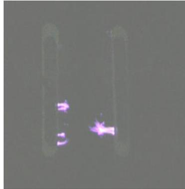
**FigV.14.2 :** Développement des zones sèches et apparition des arcs locaux
