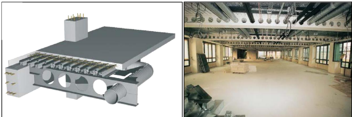
Figure 92: Plancher collaborant sur structure mixte. Source : https://www.slideshare.net/ahmedfrikha/arval-guidedesplanchersjuillet2007
