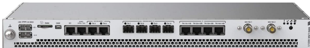
Figure II.29. Exemple d'un IDU du fournisseur ERICSSON [26]
