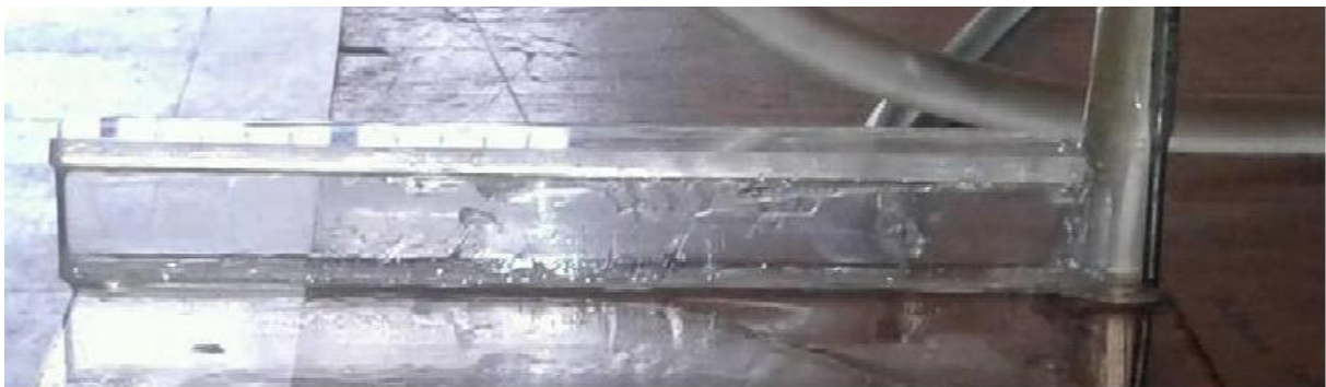
Fig.II.6. Vue détaillée du canal d'écoulement micro-fluidique.
