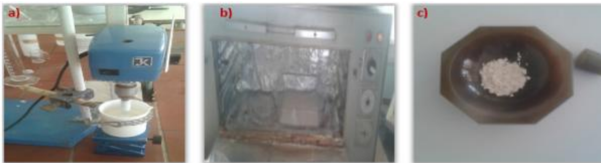
Figure II.4 : Différentes étapes de synthèse de la poudre NBT-BT
