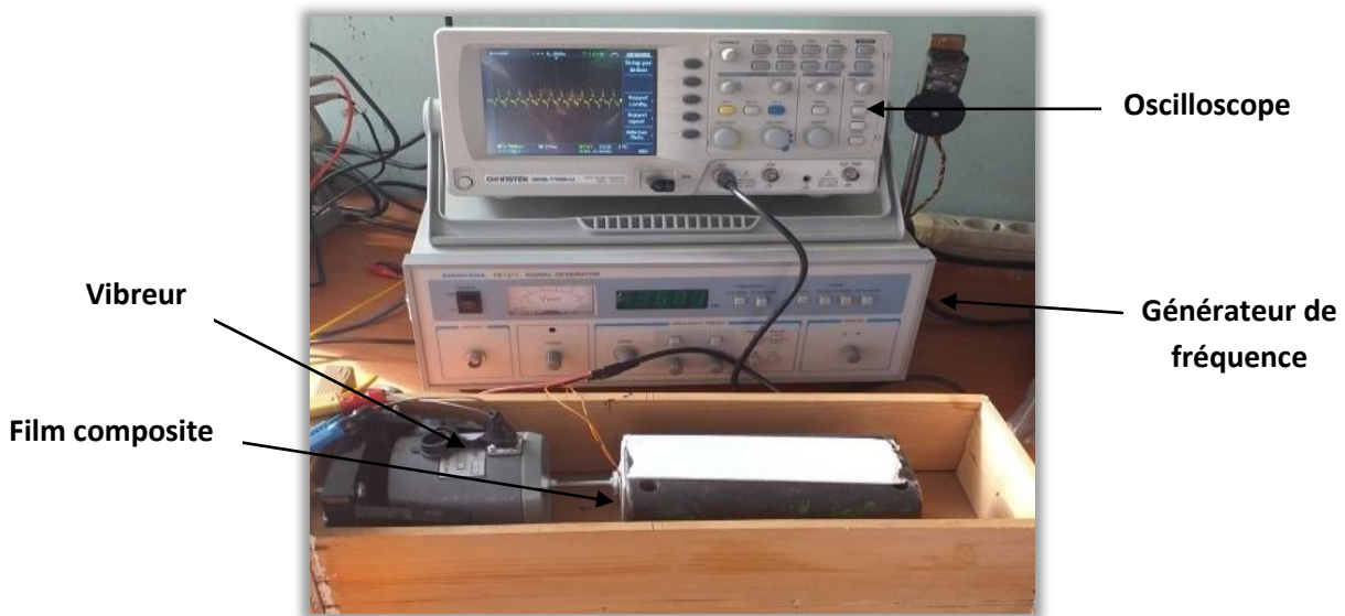
Figure II.12 : Processus de récupération d'énergie par la méthode vibratoire
