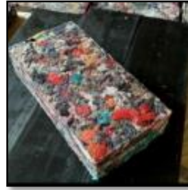
Figure 70 : Brique à base de vêtements recyclés.
