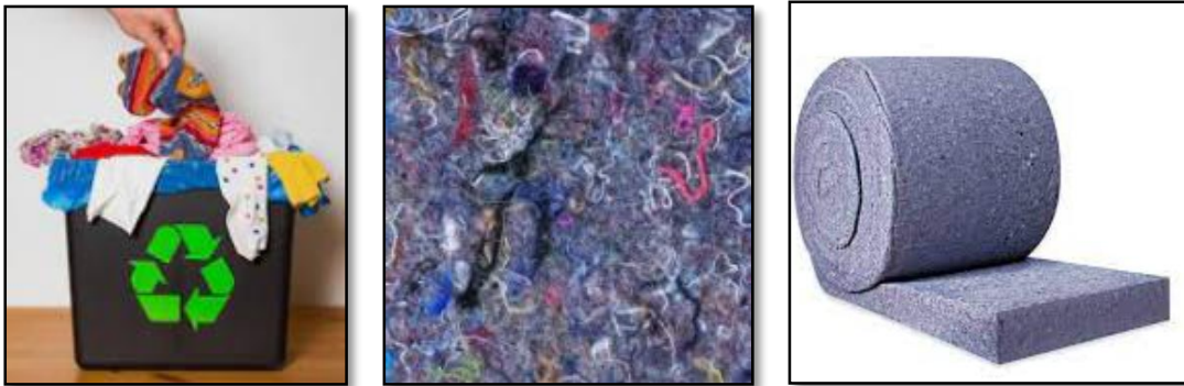
Figure 69: du textile au rouleaux isolants
