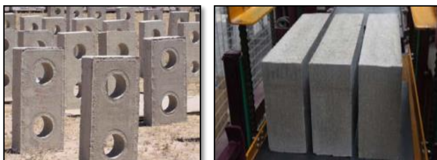
Figure 74 : Briques de carton et ciment
