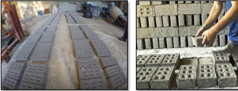
Figure 65: les briques fabriquées à base des déchets plastique
