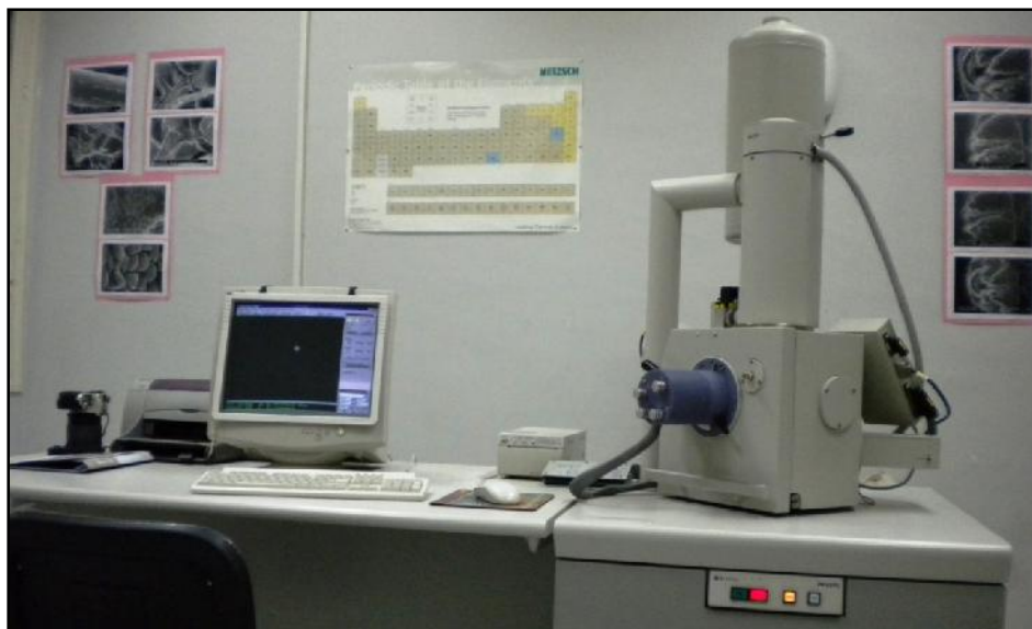
Figure III.16. Photographie du MEB Philips ESEM XL 30.
