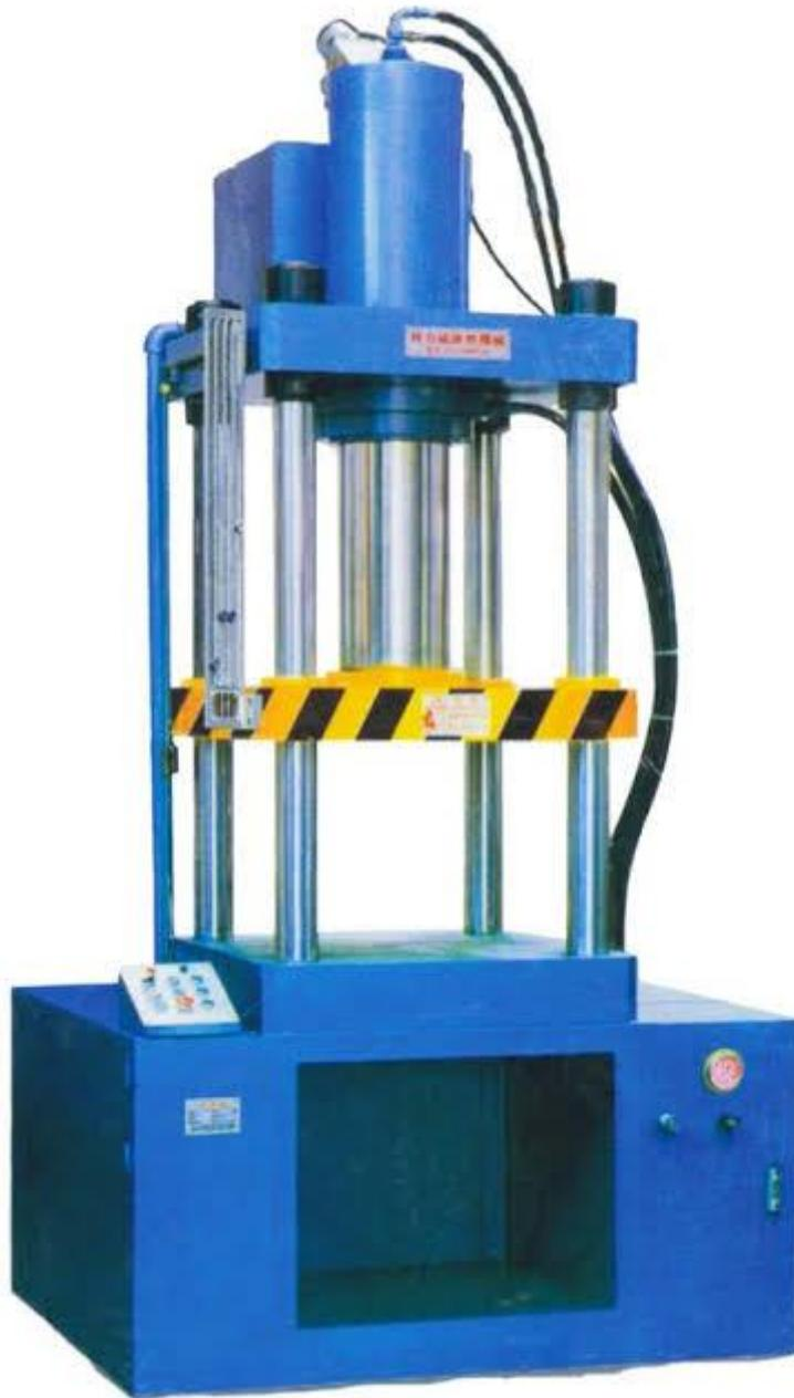
**Figure III . 11 : Presse à colonne**
