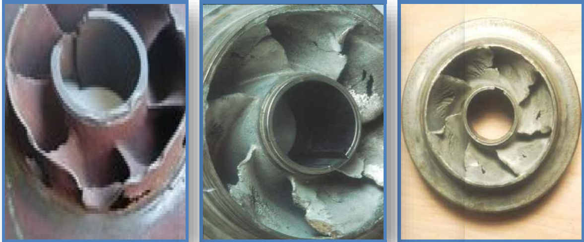
Figure V.9 : Le phénomène de cavitation sur les aubes d'une pompe centrifuge.
