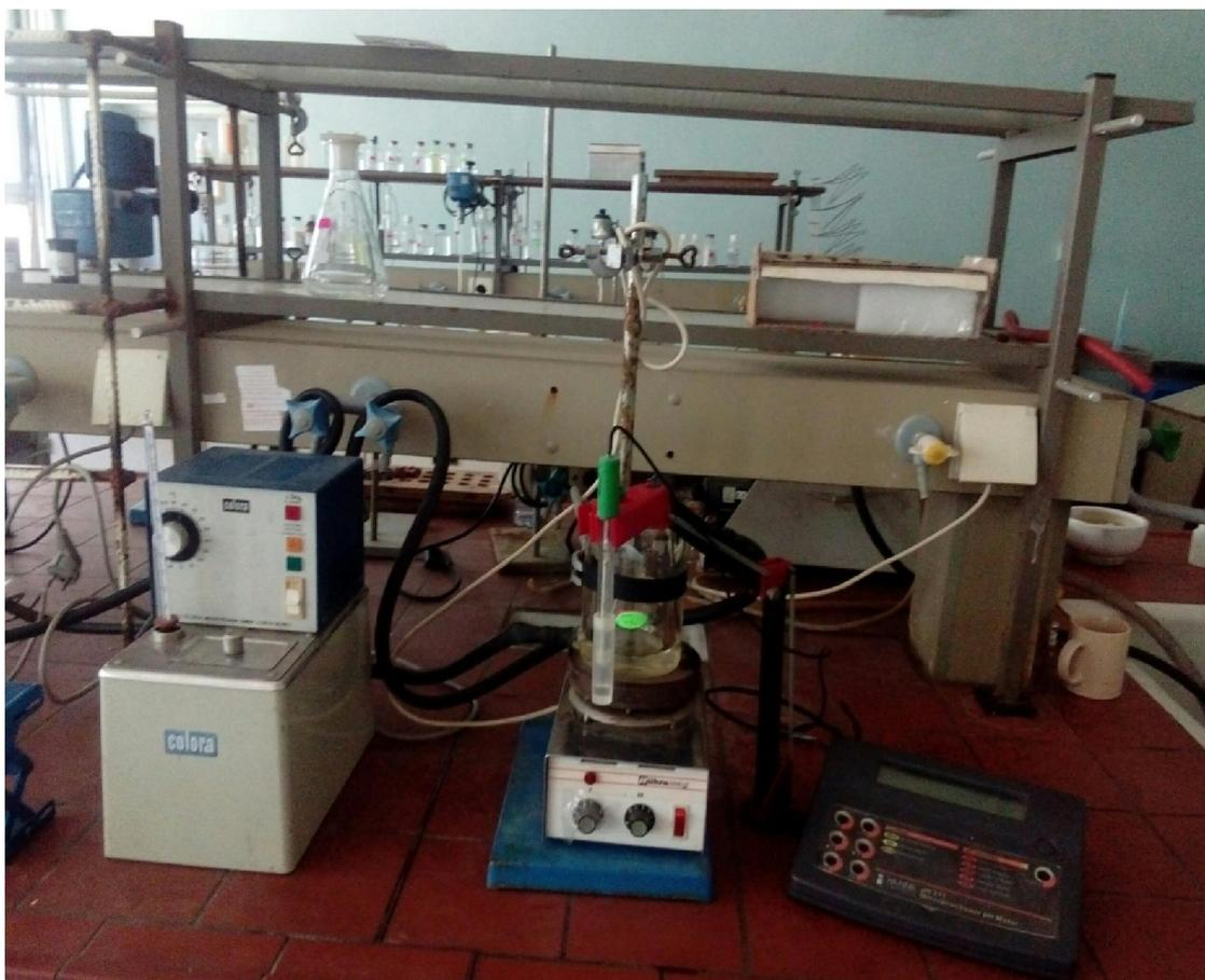
**Figure II.6 : Schéma de la cellule d'extraction liquide-liquide.**
