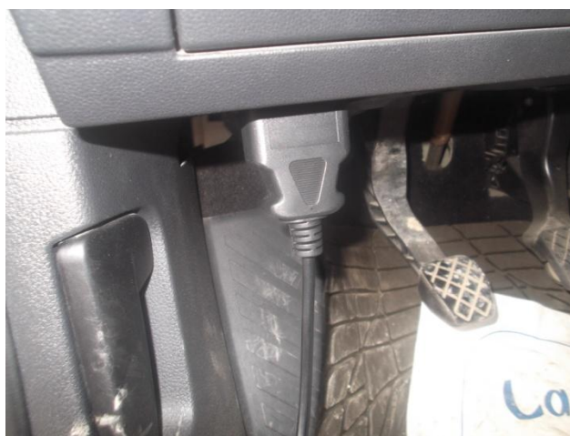
Figure 53 : Branchement de la prise obd dans la golf 5
