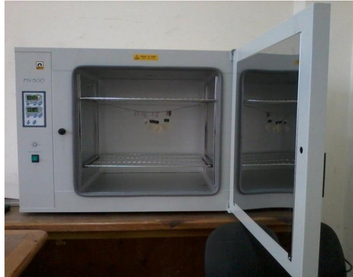
Figure IV-1 : Vue de l'étuve utilisée pour le vieillissement thermique.
