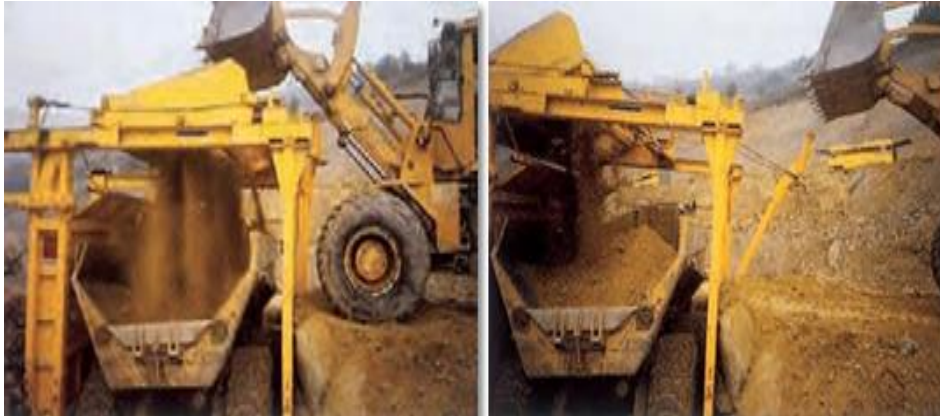
Figure VII.7. Chargement du crible et ejection des éléments grossiers par basculement de la grille
