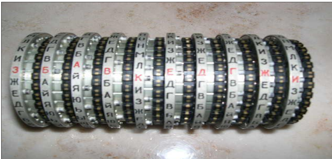
Figure 4 : Le cylindre à roues codeuses M-94/CSP-488
