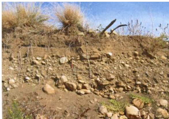
Figure 4.8 : Terrasses alluviale dans la cuvette. Matériaux de recharge, limoneux et graveleux [45]
