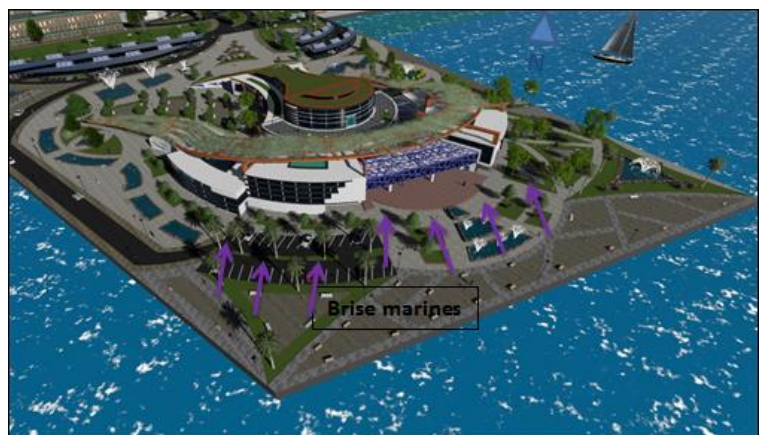
Figure 154 : schéma explicatif du captage des brises marines. Source : les auteurs.
