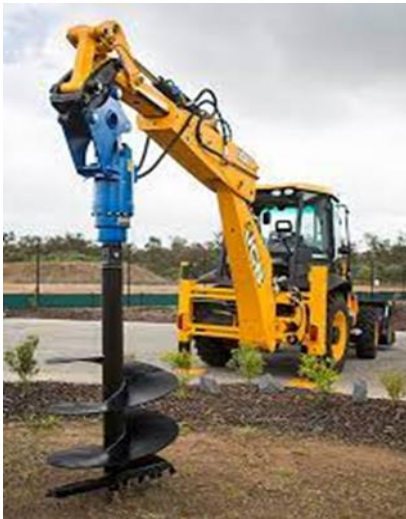
Figure 5: Tarière hydraulique, foreuse pour engin de 4 tonnes à 25 tonnes
