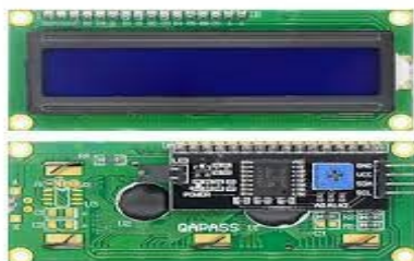
FIGURE III.6 – Module I2C monté à l'arrière d'un écran LCD 16*2[13]
