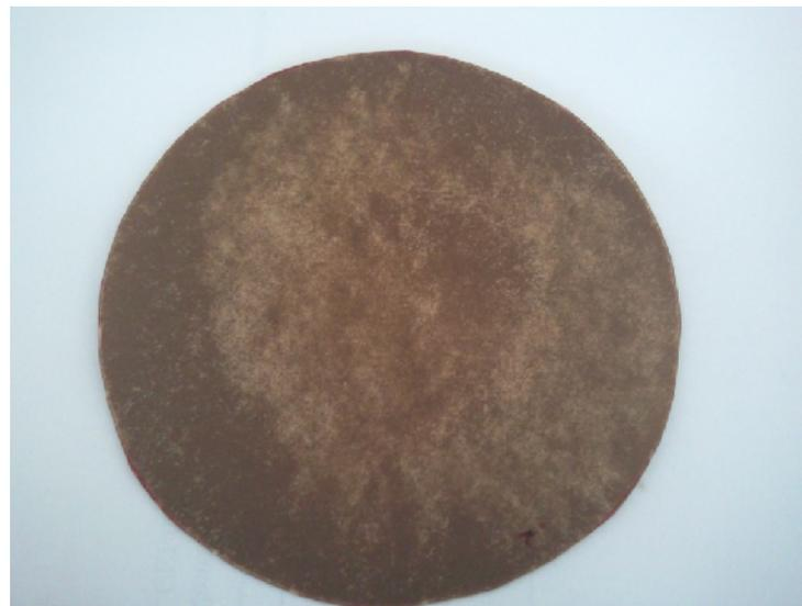
Photo 5. Echantillon du papier imprégné avec une teneur en eau de 6.5% après la décharge couronne.
