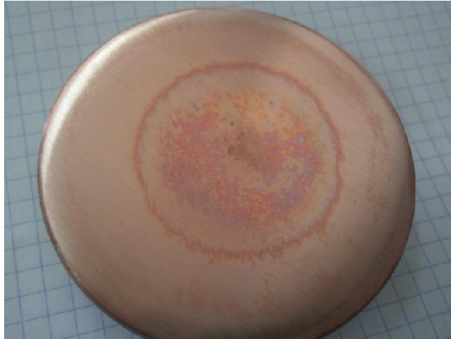
Photo 2. Plan suite à une décharge couronne avec barrière en papier non imprégné.
