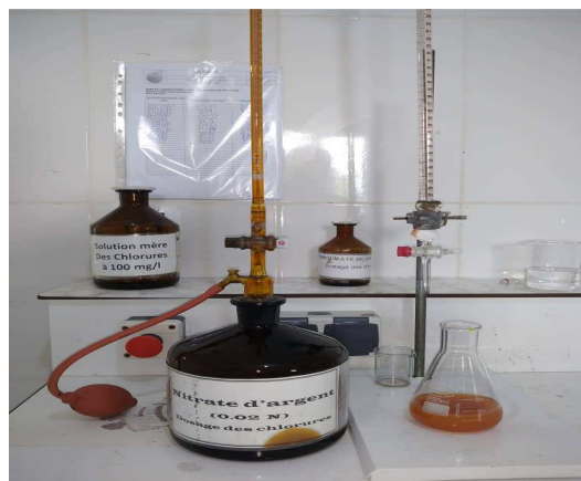
Figure 14 : Dosage des chlorures (photographie originale, 2023)
