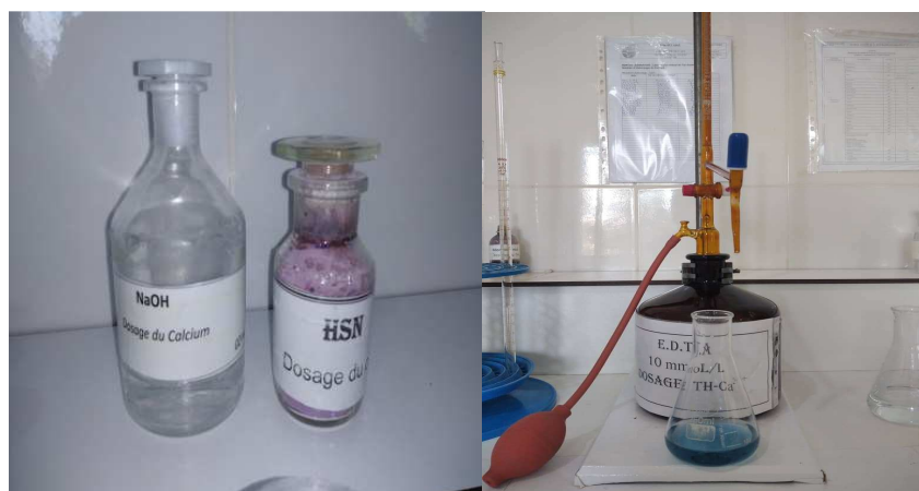
Figure 11 : Dosage volumétrique du calcium totale (photographie originelle, 2023)
