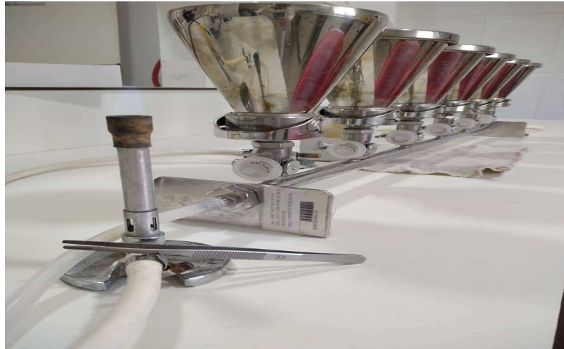
Figure20 : Dénombrement des coliformes et Escherichia coli par la méthode solide (Photographie originelle, 2023).
