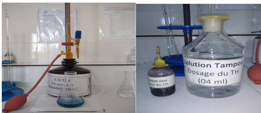
Figure10 : Dosage de la dureté totale (photographie originelle, 2023)
