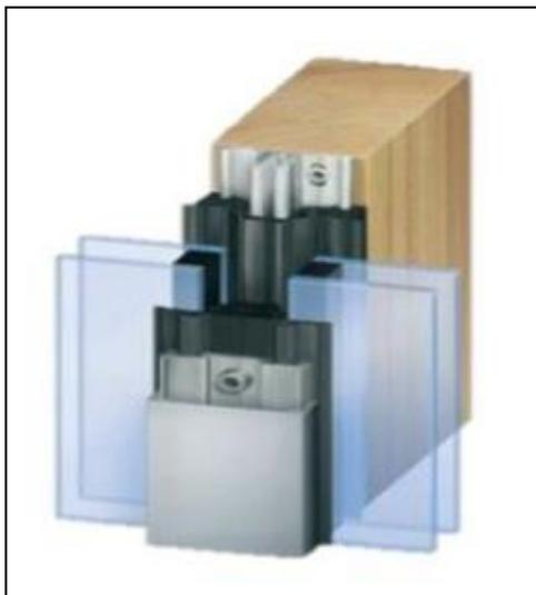
Figure119 : Détail de fixation d'un mur rideau. Source:<http://www.archiproducts.com>
