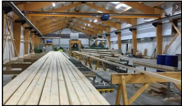
Figure105: Fabrication de poutres en bois lamellé collé
