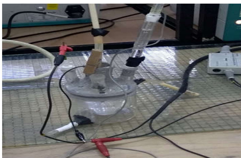
Figure II.1 : Photographie d'une Cellule électrochimique à trois électrodes
