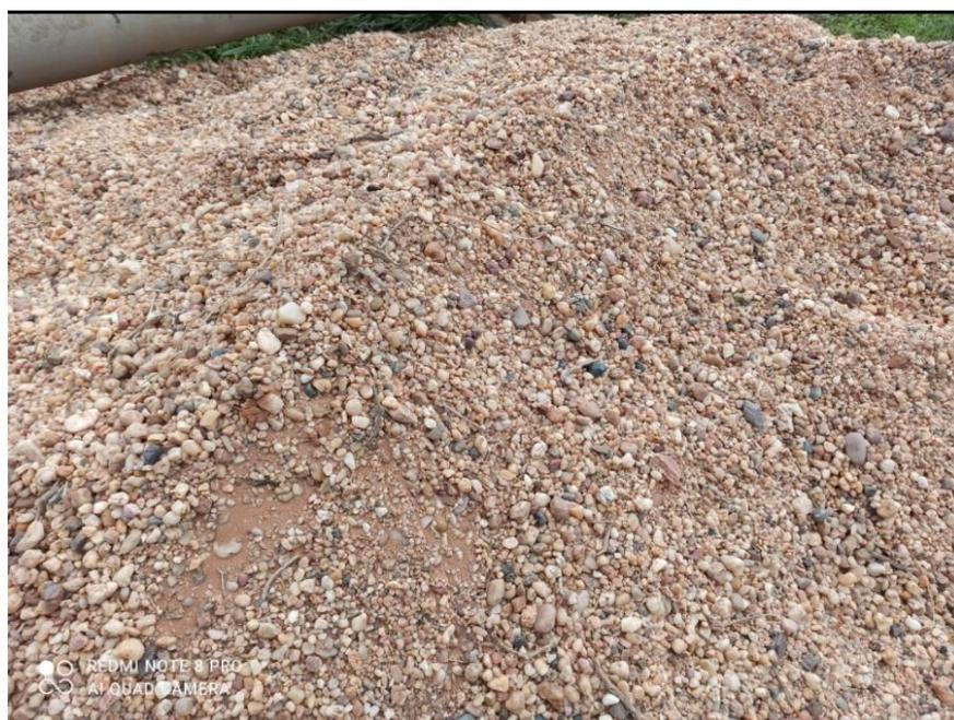
*Figure 41 : massif filtrant utilisé dans le forage.*
