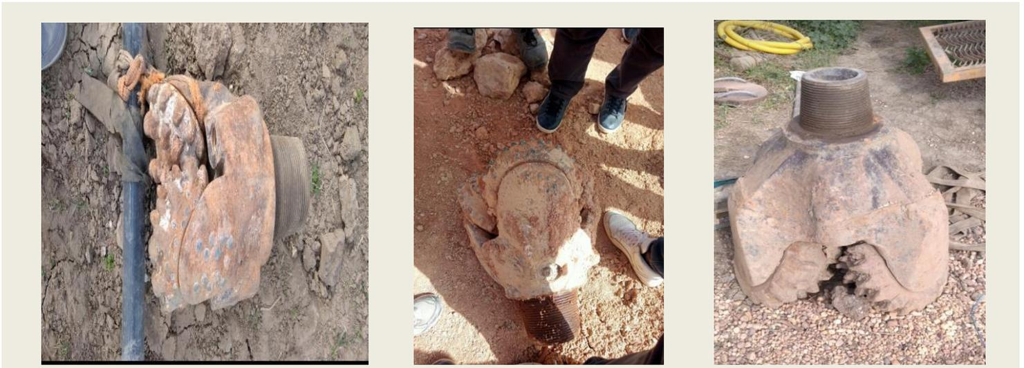
*Figure 25: Tricônes de différents diamètres.*
