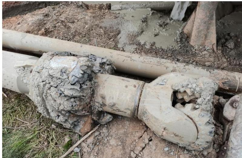
*Figure 39 : tricônes de 17'' et 22'' assemblés.*
