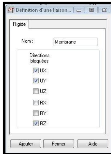
Figure V.18. Définition des directions à bloquer
