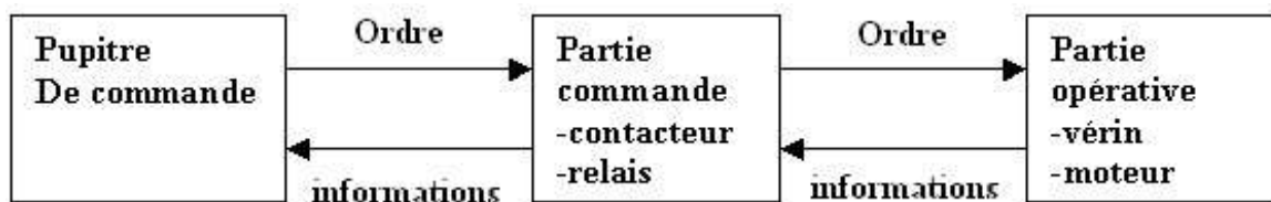
Figure I-4 Positionnement du pupitre dans un système automatisé.
