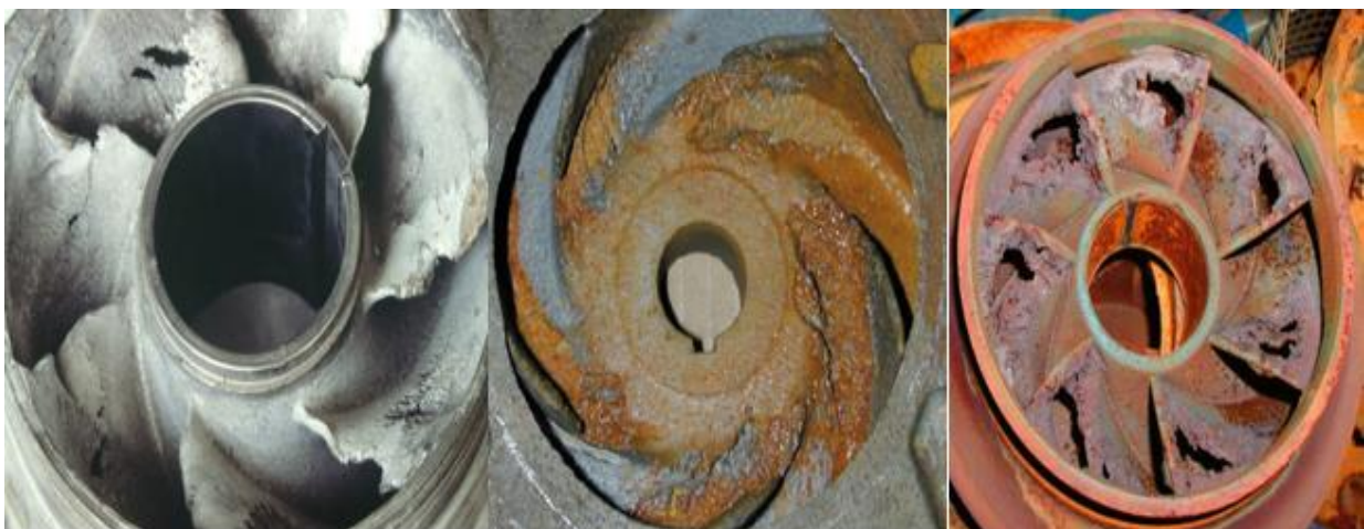
Figure V.7: Photos illustrant les dommages causés par le phénomène de cavitation sur les aubes d'une pompe centrifuge
