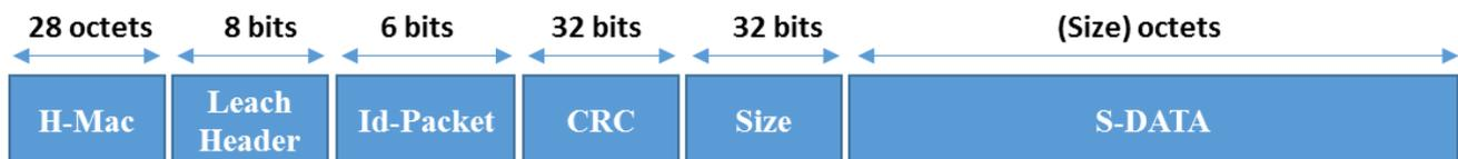
Figure IV-5. Format d'un paquet chiffré dans DHD-LEACH.
