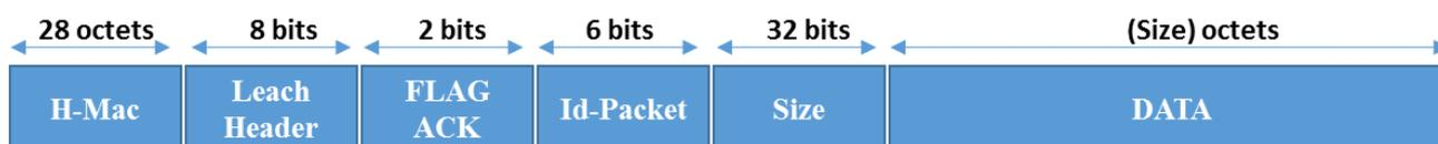
**Figure IV-3. Format d'un paquet de données dans DHD-LEACH.**
