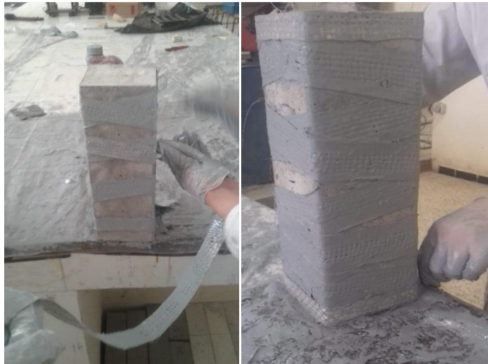
Figure. II.14: a-Collage du tissu sur le prisme en béton, b- prisme confiné avec une double hélice
