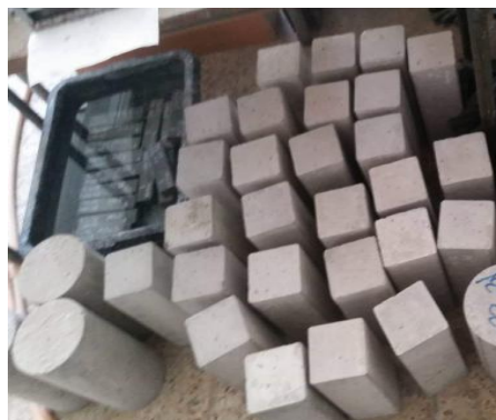
Figure. II.10. Les éprouvettes avant confinement.
