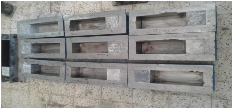
Figure II.6 : Moules métalliques de dimensions ( 10\text{cm} \times 10\text{ cm} \times 30\text{cm} ).
