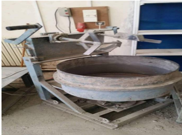
Figure. II.4 : Malaxeur à axe vertical.
