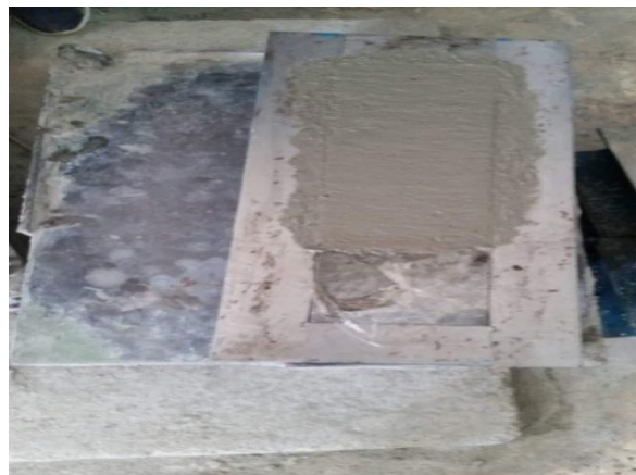
Figure II.7: Vibration du béton sur la table vibrante.
