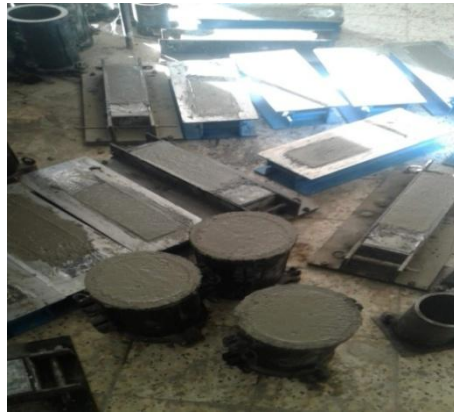
Figure. II.8 : Moules remplis de béton.
