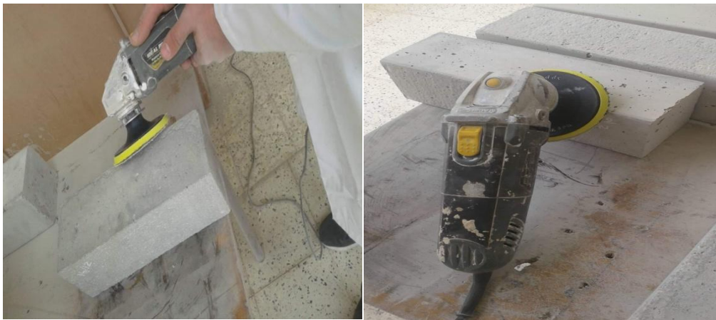
Figure II.11 : arrondissement des arrêtes des prismes avec une ponceuse électrique.
