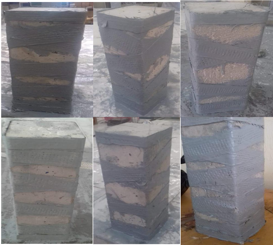
Figure II.15: éprouvettes confinées, laissées sécher à température ambiante.
