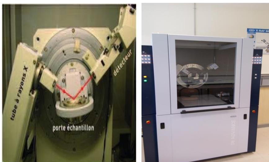
**Figure III.3** : Schéma d'un diffractomètre de rayons X Brukers D8 Advance (de laboratoire LASMIS antenne de Nogent).
