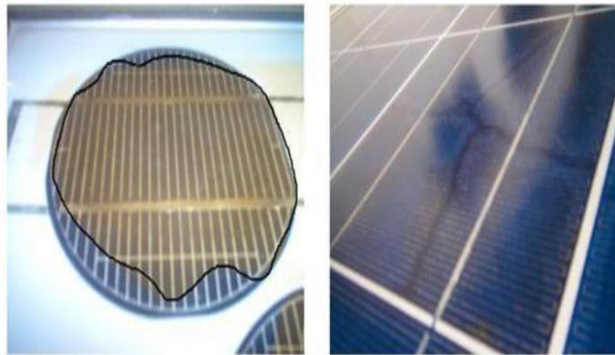
**Figure II.11** : Modules photovoltaïques avec des cellules décolorées [109].
