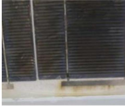
**Figure II.9 :** Corrosion des interconnexions d'un module c-Si [107].
