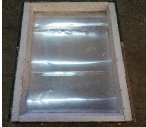
Figure IV.24 : Isolation du boîtier avec du polystyrène
