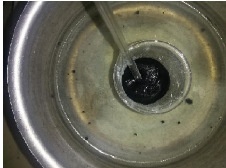
Figure IV.9 : Emplacement du récipient dans le bain-marie.
