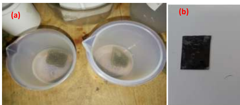
Figure II.5 : (a) structuration binaire du Silicium : texturisation en pyramides couplée à une nanostructuration en nanofils (b) image de l'échantillon obtenu
