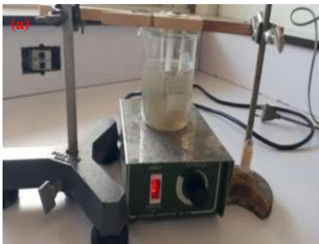
Figure II.7: Evolution de la réaction et changement de la couleur dans le bêtecher (a) avant et (b) après 16 min du début du dépôt du PbS
