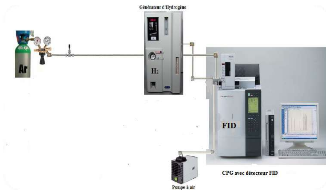
Figure II.12: Montage de la caractérisation par chromatographie gazeuse utilisée [7]
