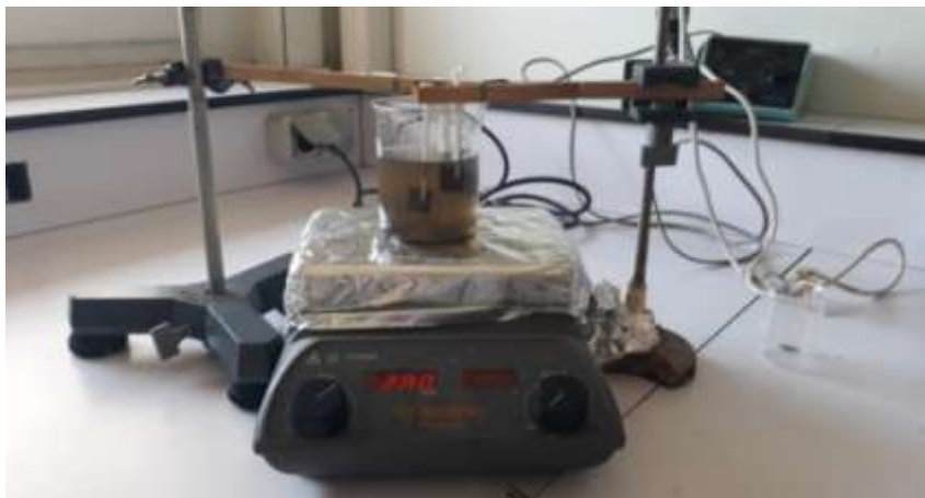
Figure II.6 : Préparation du bain chimique pour le dépôt de couche mince de PbS
