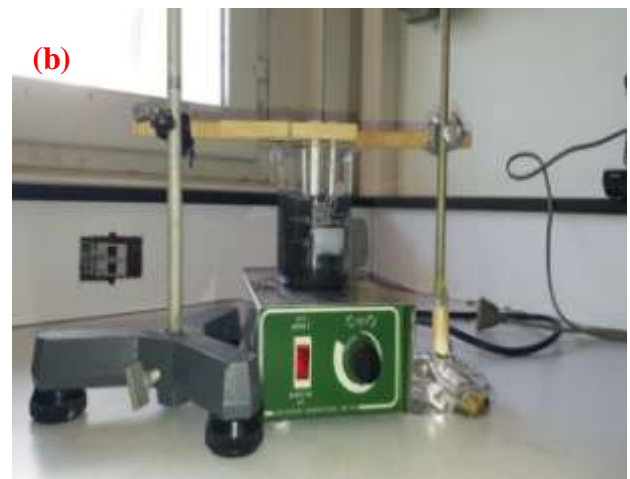
Figure II.7: Evolution de la réaction et changement de la couleur dans le bêtecher (a) avant et (b) après 16 min du début du dépôt du PbS
