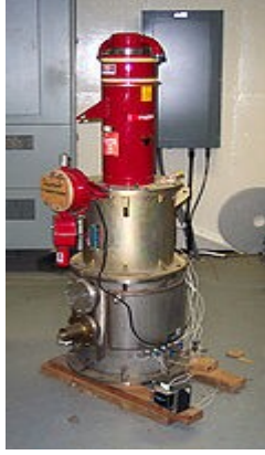
Figure II-13 : klystron pour communication spacial
