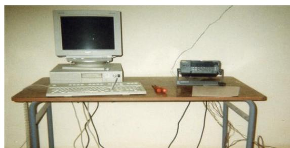
Photo 2.2. Système d'acquisition de données installé à l'intérieur du local (Enregistreur de type Fluke à 20 voies sur lequel sont placés les thermocouples branché à
