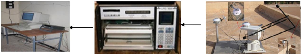
**Figure 3.1 :** Appareil de type Synt Tracker mesurant l'irradiation diffus, direct et le global connecté à un enregistreur de type LPD12 6.10 et branché sur PC
