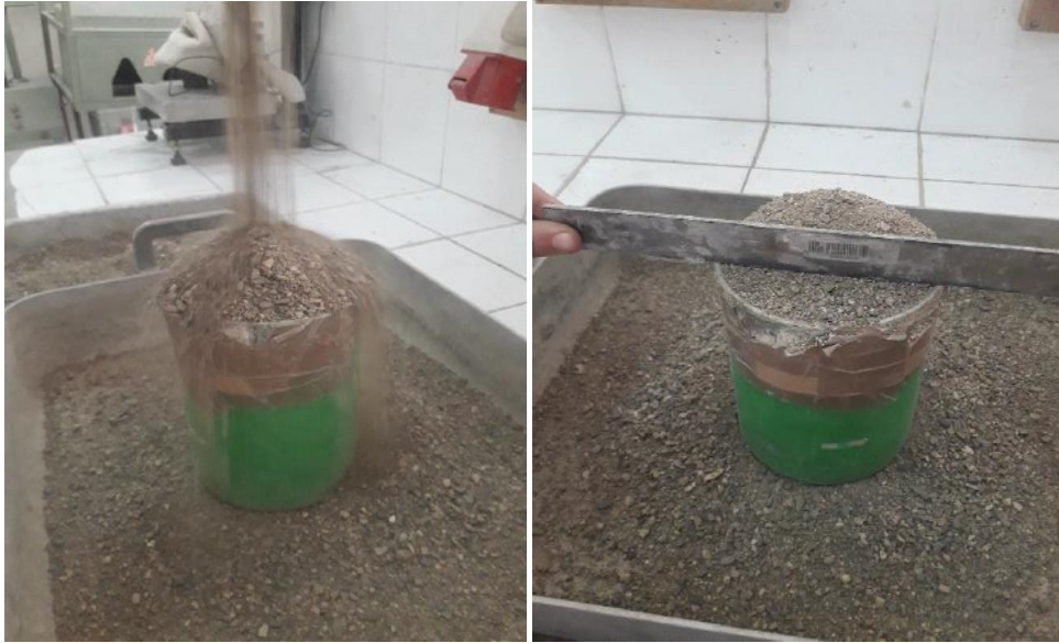
Figure III-4 : Essai de détermination de la masse volumique apparente du sable
