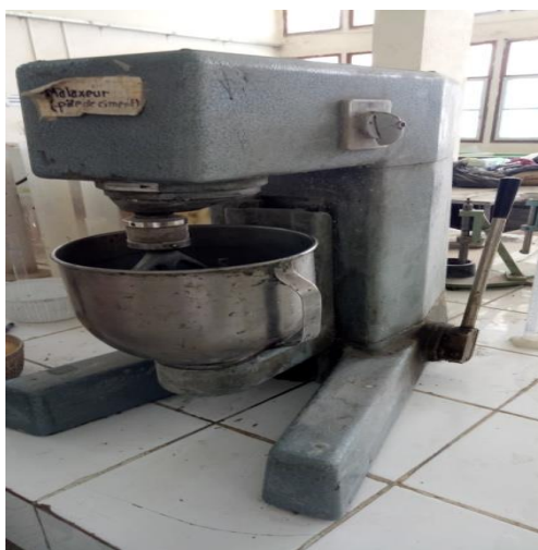
Figure III.9 : Malaxeur électrique utilisée dans la fabrication du mortier [Labo Béton – UMMTO]
