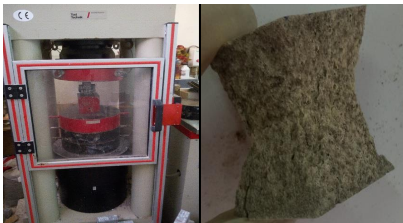
Figure III.16 : Dispositif de l'essai mécanique de Compression [Laboratoire UR-MPE/FSI-Boumerdes]
