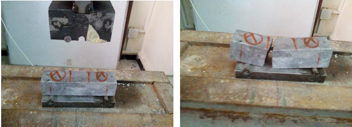
Figure IV.19 : Etat de l'éprouvette après l'essai de flexion 4 points
