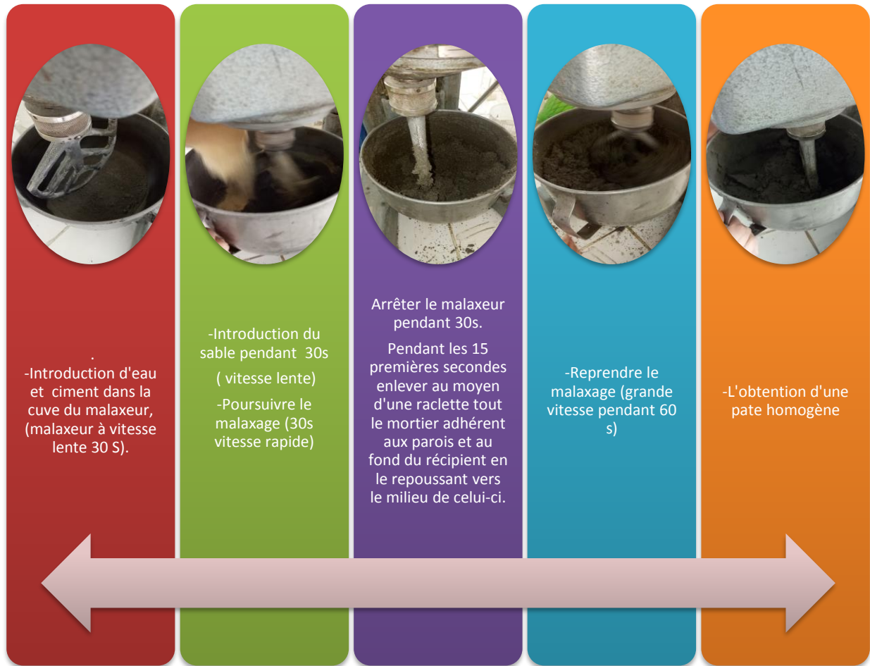
Figure III.10: Les étapes de malaxage du Mortier normalisé
