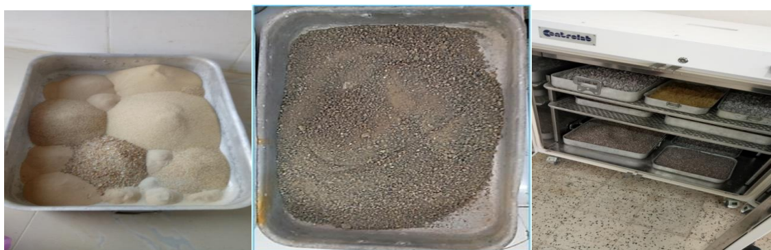
Figure III.2 : Lavage et séchage des granulats utilisés dans les différentes formulations du mortier.
