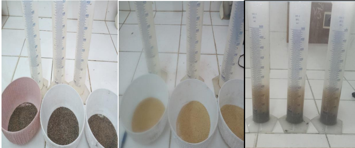
Figure III.3 : Essai de la détermination de la masse volumique absolue du sable.
