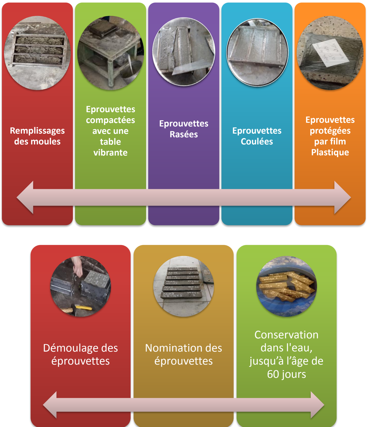
Figure III.11 : Remplissage et Conservation des épreuves du mortier normalisé [Photos prises au laboratoire de béton Génie Civil- UMMTO]
