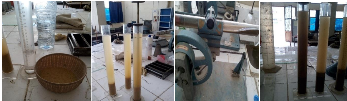
Figures III.5: Principe de l'essai d'équivalent de sable
