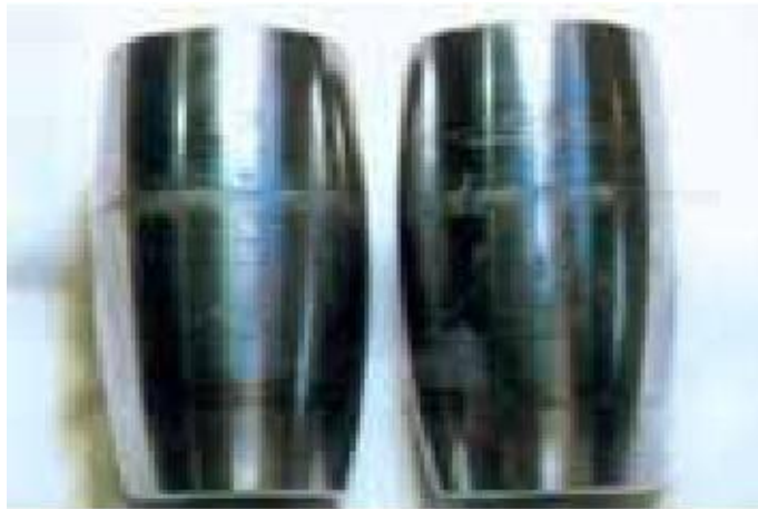
Figure II.22: écaillage en peau d'organe (peeling). [7]
