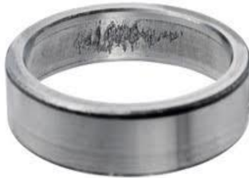
Figure II.13: déformation du chemin de roulement. [7]
