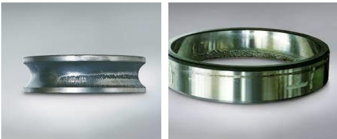
Figure II.9: l'écaillage des pistes. [7]
