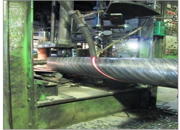
Figure 23 : Soudage par la machine automatique
