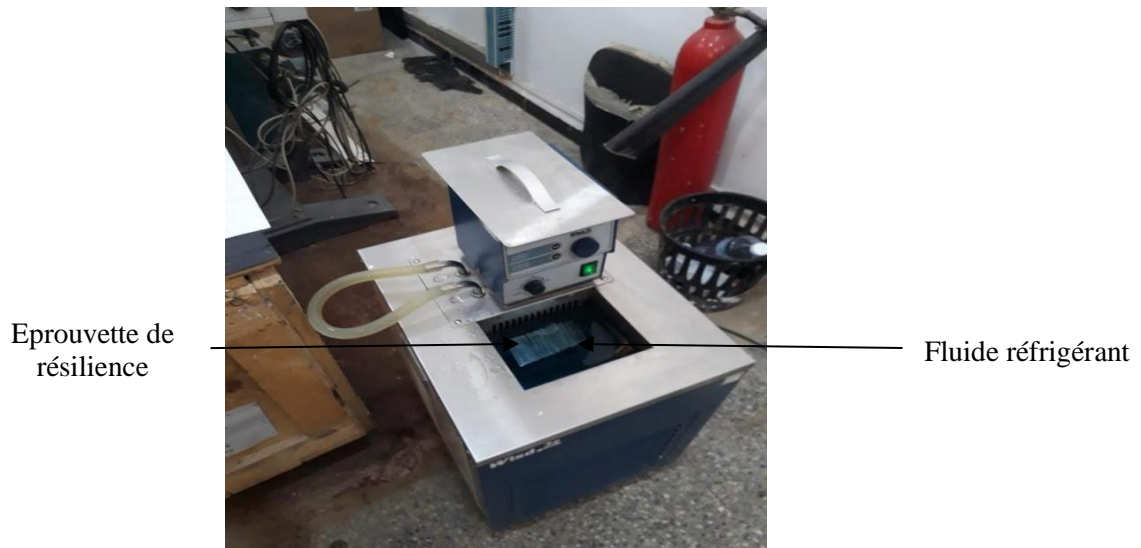
Figure 47 : machine pour refroidissement d'éprouvette
