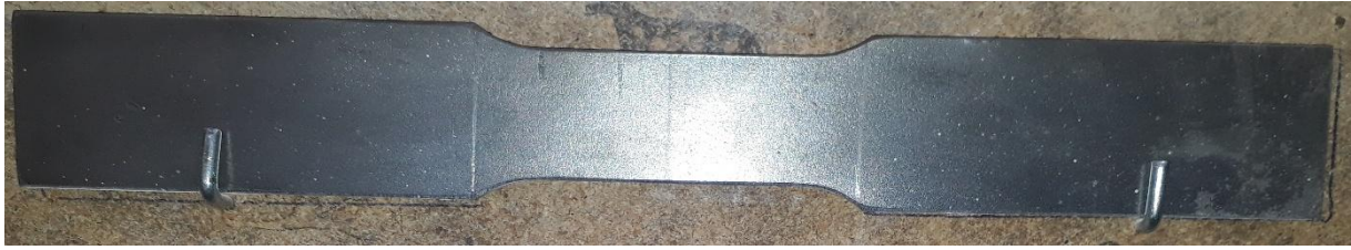
Figure (56) : éprouvette du métal de base avant la striction.
