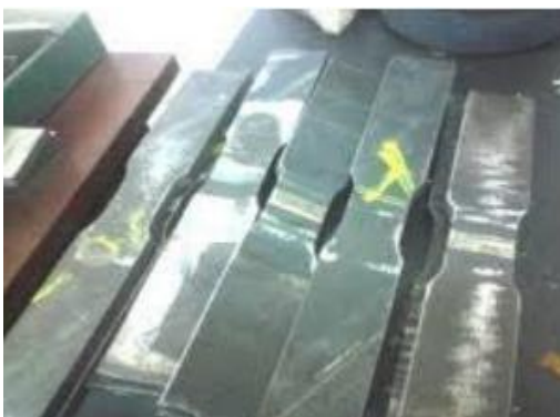
Figure 43 : Eprouvette d'essai de traction selon la norme AFNOR.
