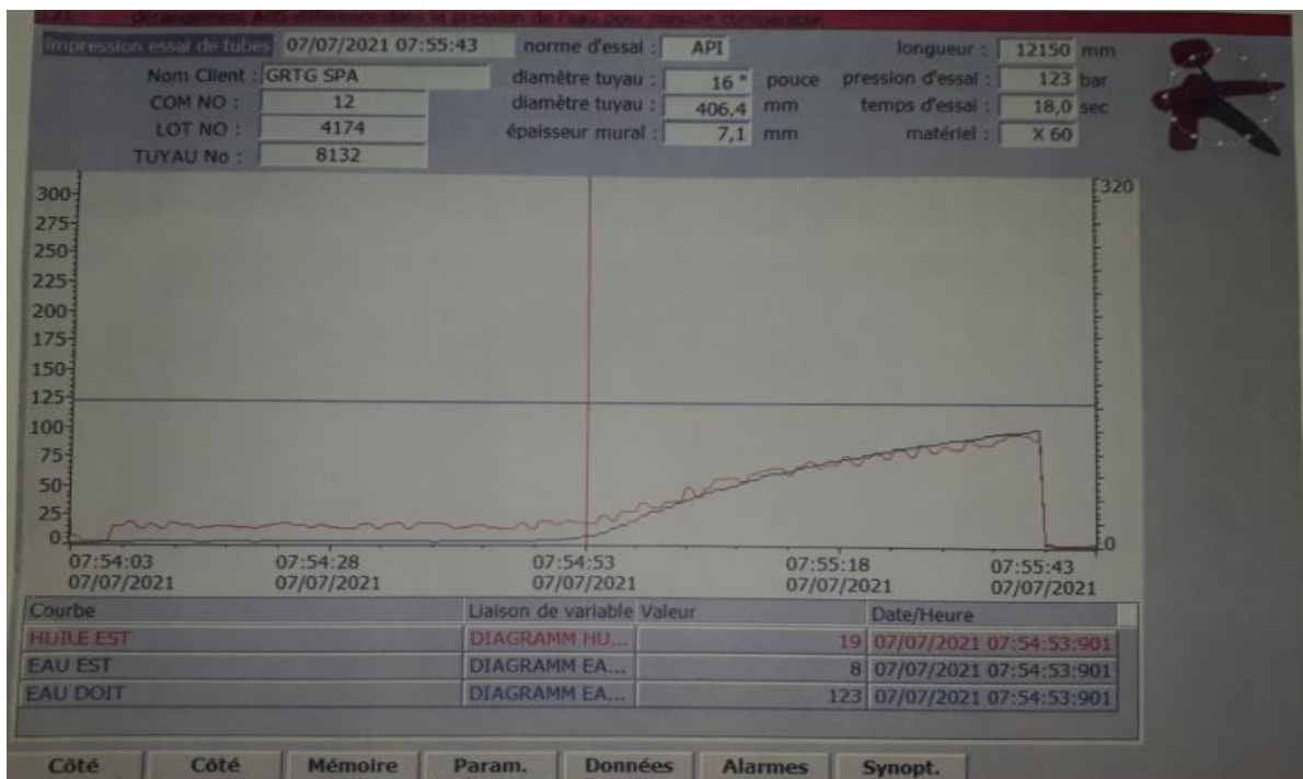
Figure 33 : graphe montrant un tube défailant
