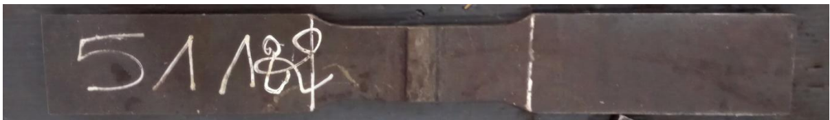
Figure 61 : éprouvette avec cordon de soudure avant rupture
