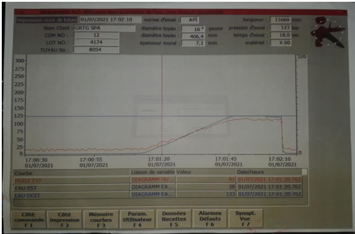
Figure34 : graphe montrant un tube défaillant
