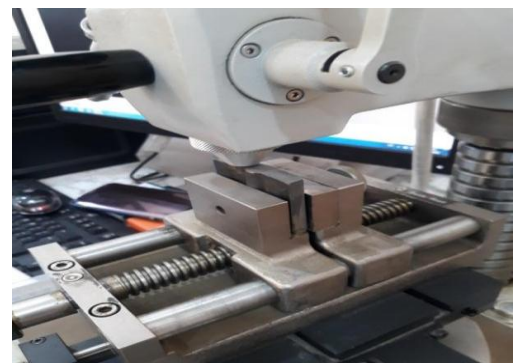
Figure 44 : Réalisation de l'essai de dureté ; Machine de dureté Vickers
