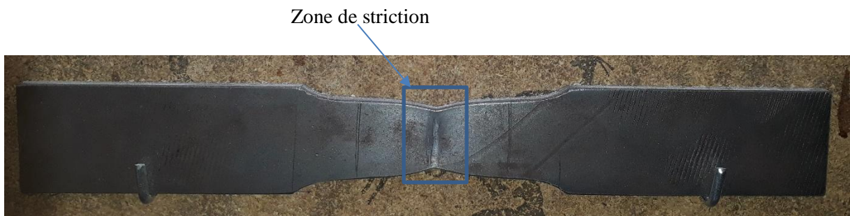
Figure (57) : éprouvette du métal de base après striction.
