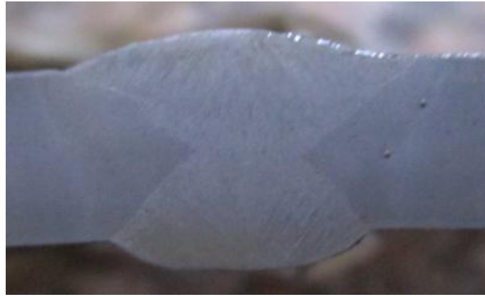
Figure 51 : Epreuve montrant le cordant de soudure apprêttraitement chimique
