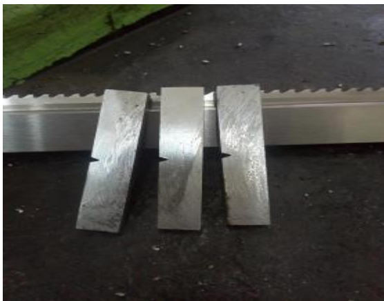
Figure 49 : Eprouvette avant destruction
