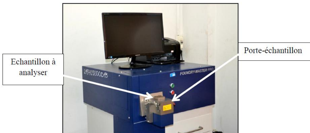
Figure 52 : Spectromètre à émission optique utilisé pour l'analyse chimique
