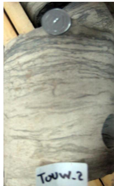
Figure.16 : Les litages en flasers (Flaser bedding) TOUW-2, C5,3653 m
