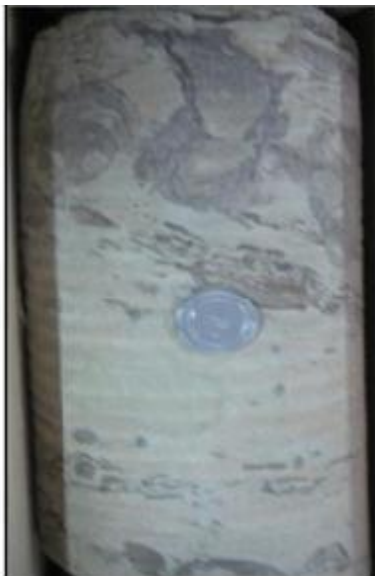
Figure.23 : Asterosoma dans un grès fin à stratification plane légèrement oblique et à galets et drapages d'argile TOUC-1, C3, 2412.10m
