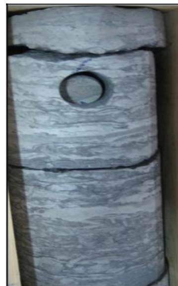
Figure.24 : Facies hétérolithique assez bioturbé de type planolites TOUC-1 C3, 2408m
