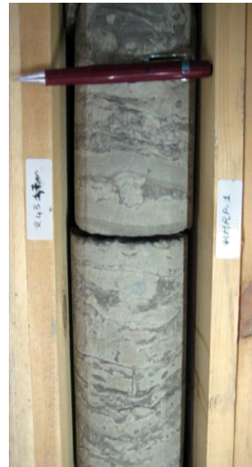
Figure.20 : Grés gris fin poreux à galets d'argile sédimentaire TOUC-1, C4,3436.7 m
