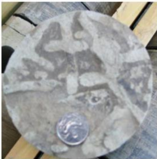
Figure.15 : Les drapages argileux (Mud draps ou mud layers) TOUW-2, C1,3542.25 m
