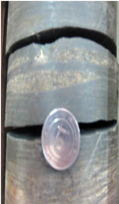
Figure.17 : Les litages lenticulaires (Lenticular bedding) ETB-2, C4,3621.25 m
