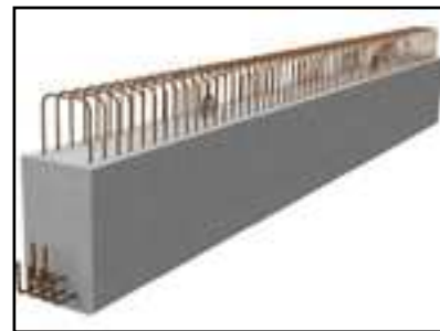
Figure 35 : vue sur poutre en béton armé Source : www.structalis.fr
