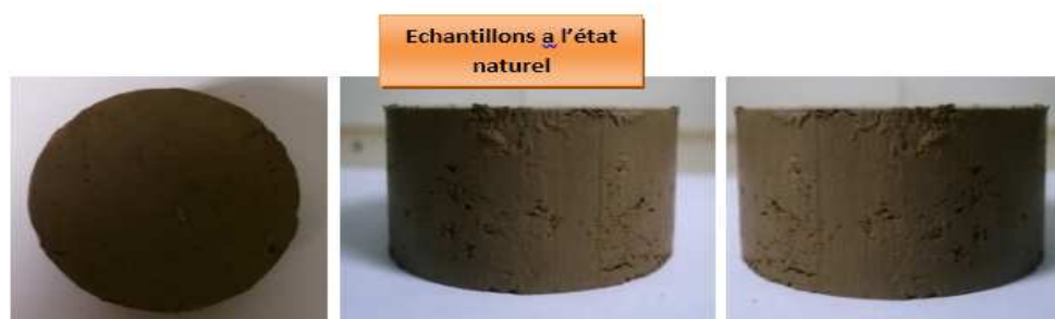
Figure IV.22 : Images de l'échantillon d'argile N°1 de Tizirt pendant l'essai de canicules.
