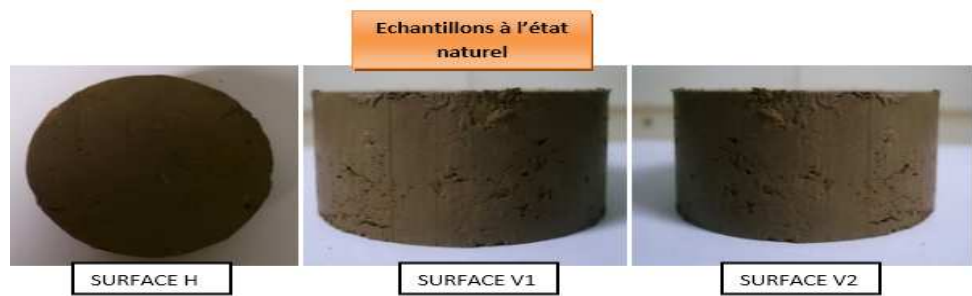
Figure IV.16 : Images de l'échantillon d'argile de Tizgirt pendant l'essai de Dégradabilité, à l'état naturel et après chaque cycle.
