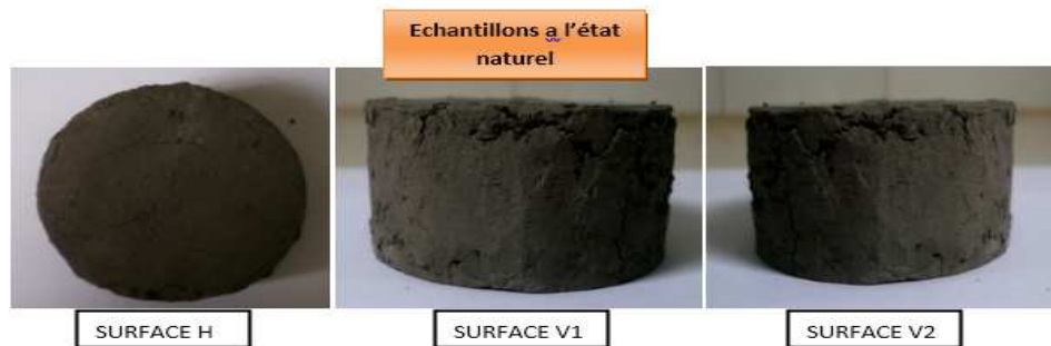
Figure IV.21 : Images de l'échantillon d'argile N°01 d'Azazga pendant l'essai de canicule.
