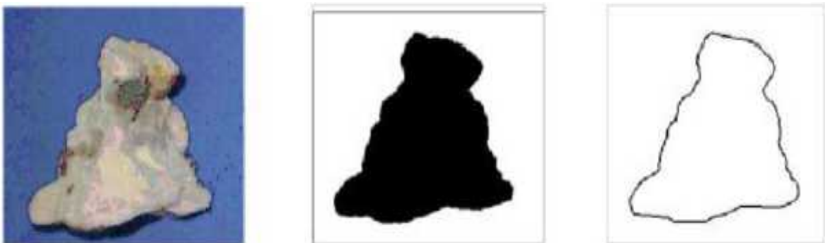
Figure III.10. Exemple d'une image binaire obtenue après l'analyse d'image d'un grain de sable (ACHIR.M, 2011).
