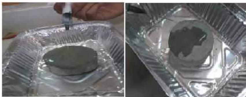
Figure IV.50. Mouillage des échantillons à l'aide d'une seringue.
