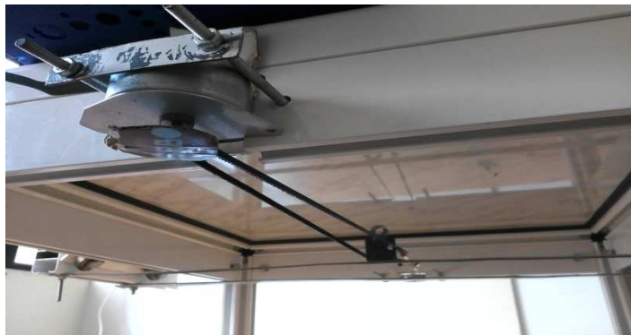
Figure III.3 : le couroïl qui entraîne l'axe X
