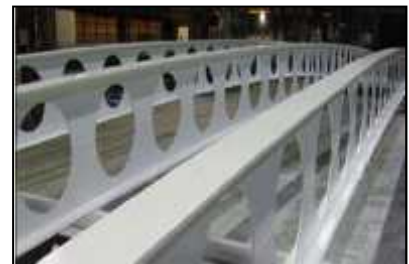
Figure 135 : les poutres alvéolées
