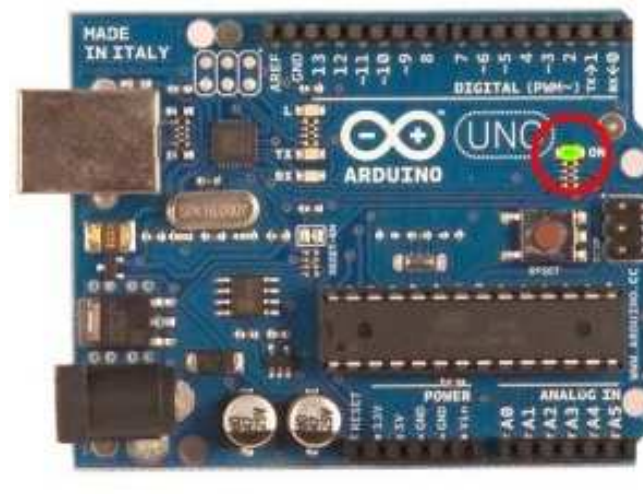
Figure31 : Carte connectée et alimentée.
