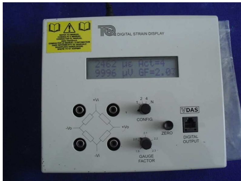
Figure 5 :L'électronique du banc didactique d'étude des jauges
