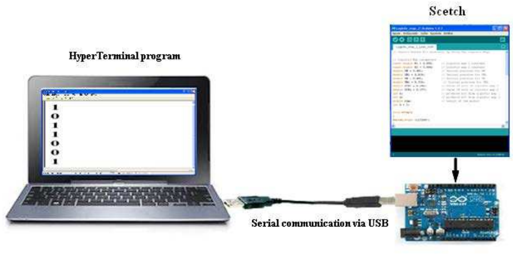
Figure 30: Branchement de la carte ARDUINO-UNO.
