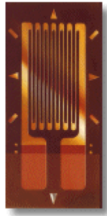
Figure 9 : jauge de contrainte
