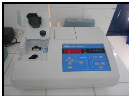
**Figure 6.** Turbidimètre optique et électronique HACH modèle 2100N (appelé aussi néphélométrie).
