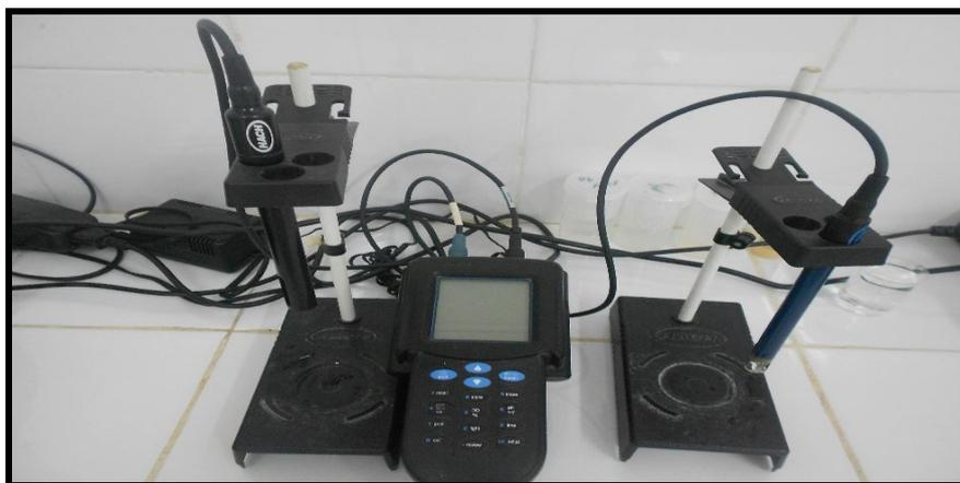
Figure 7. Multi-paramètre HACH.
