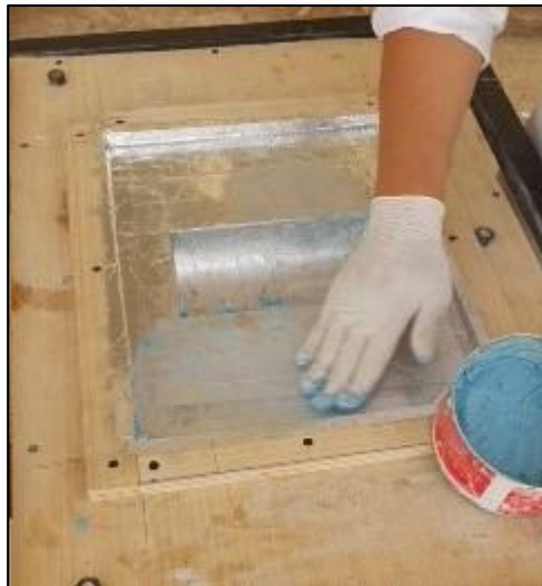
Figure III.20 : Application de cire de démoulage
