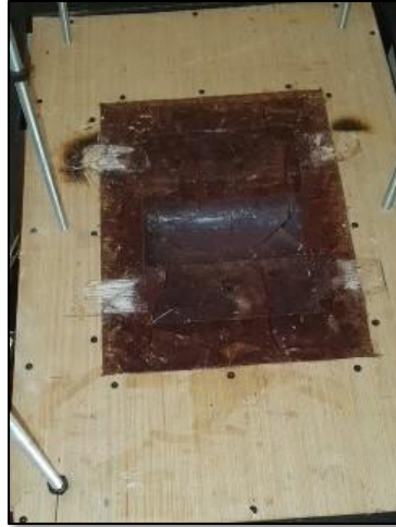
Figure III.15 : Empreinte inférieure après le démoulage
