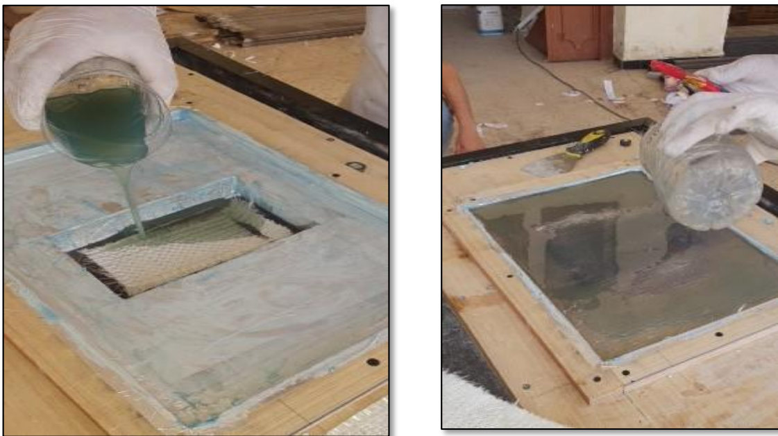
Figure III.21 : Fabrication empreinte supérieure
