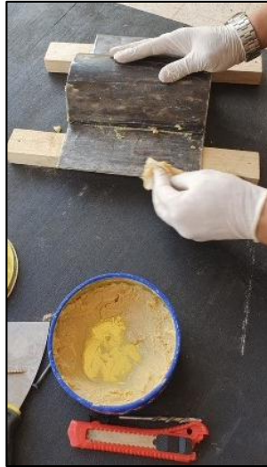
Figure III.10 : Application de cire sur la surface de pièce
