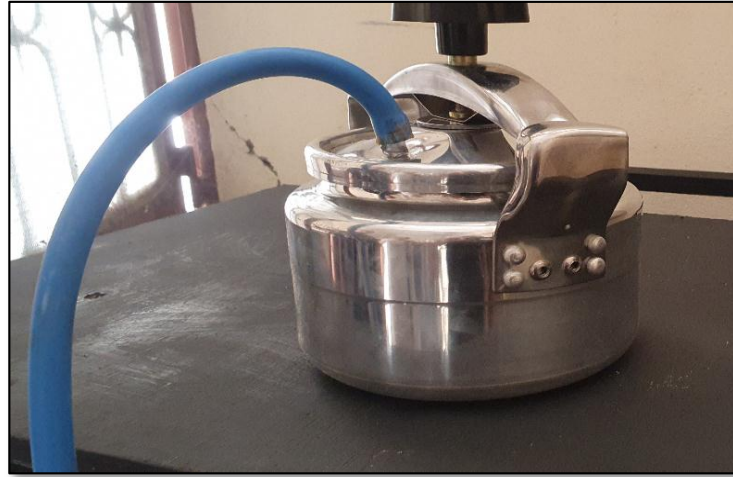
Figure III.28 : Réservoir de résine
