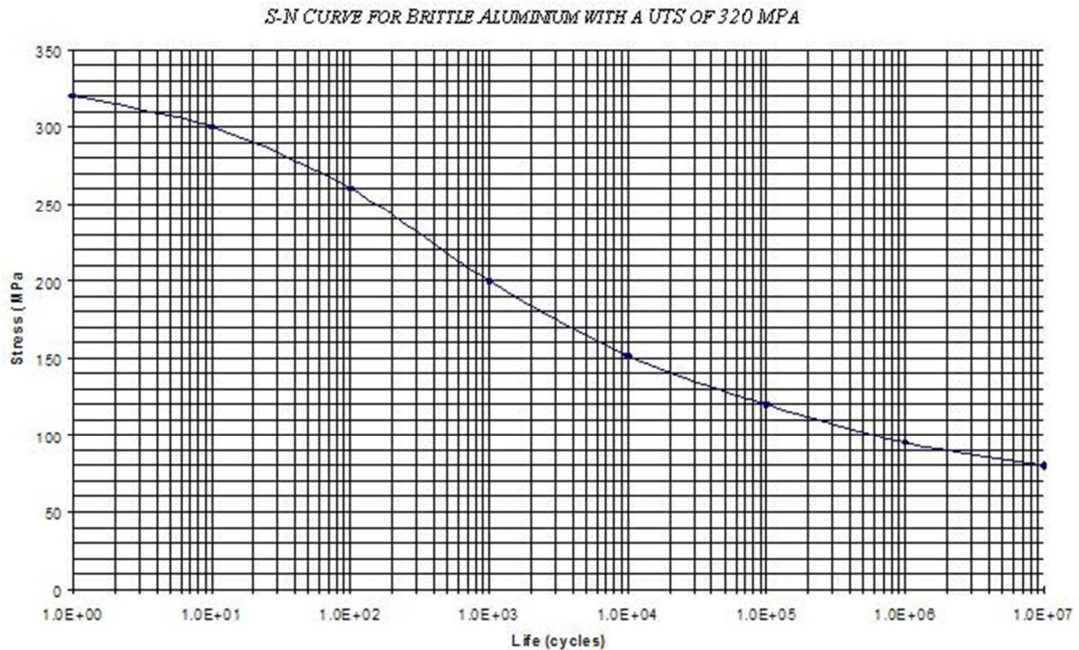
Figure1 : Courbe de Wöhler pour un alliage d'aluminium. [2]
