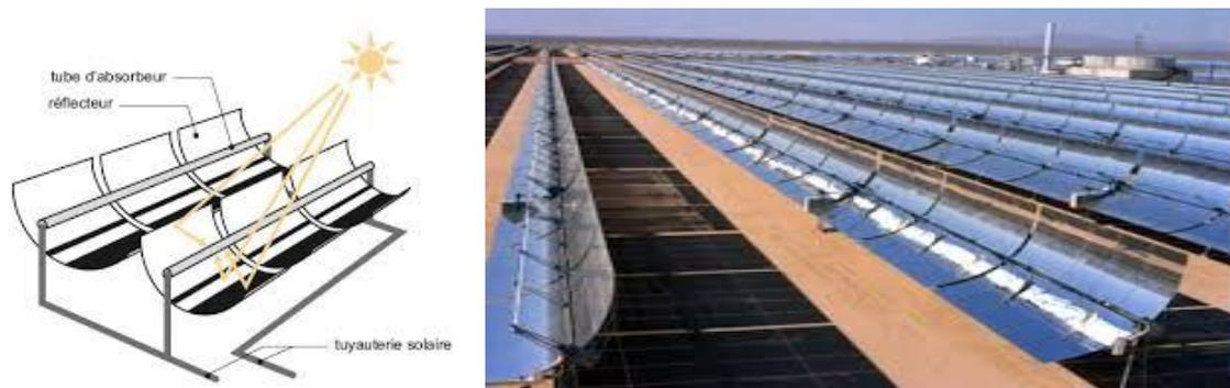
Figure II-05 : Capteur cylindro-parabolique
